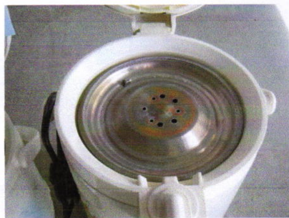
หมายเลข 67-71 กระจกน้ำร้อน พลาสติกกรอบแตก นี้อตเป็นสนิมหลุด ไม่สามารถซ่อมได้
