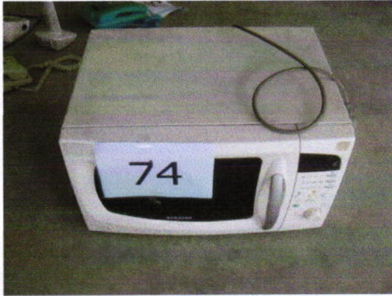
หมายเลข 74 ไมโครเวฟ ไฟช็อตไหม้
