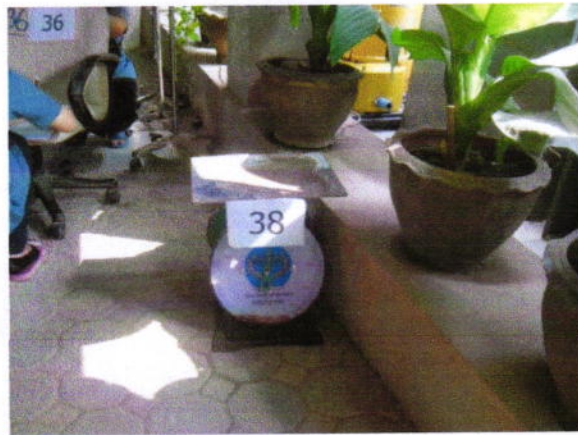
หมายเลข 38 กิโลซิ่งน้ำหนัก 120 kg. ตราซิ่งไม่ตรง เป็นสนิม
