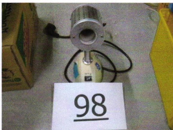
หมายเลข 98 เครื่องเผาเหล็กเย็บเชือกชำรุด ขดลวดทำความร้อนขาด ข้างไม่สามารถซ่อมได้
