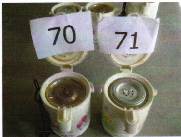
หมายเลข 67-71 กระจกน้ำร้อน พลาสติกกรอบแตก นี้อตเป็นสนิมหลุด ไม่สามารถซ่อมได้
