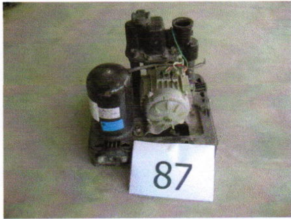
หมายเลข 87-90 ป้อนน้ำมิตซู มอเตอร์ไหม้ ไม่สามารถใช้งานได้
